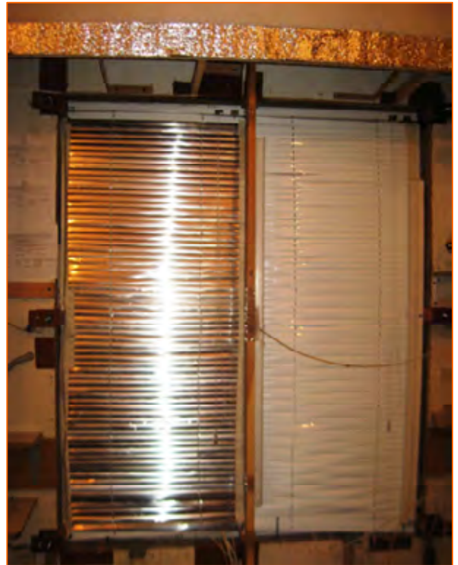
Рис. 5. Испытание влияния установки жалюзи на сопротивление окна: жалюзи очищенные (слева) и эмалированные (справа)
