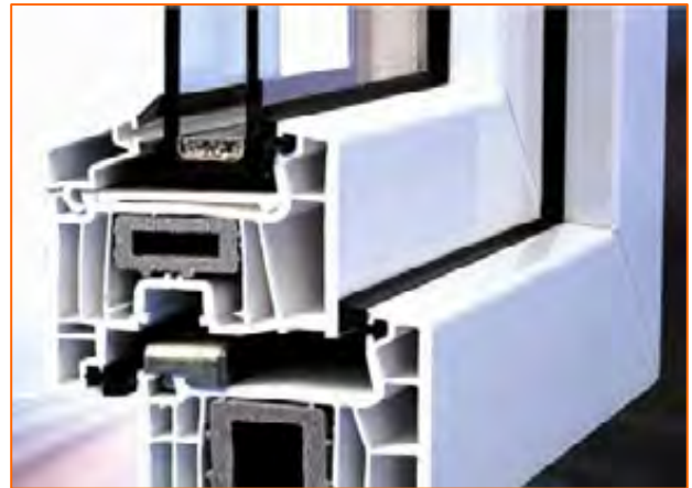
Рис. 5. Применение в ПВХ-профилях вместо стальных усилителей композитного армирующего профиля вспененным ПВХ
