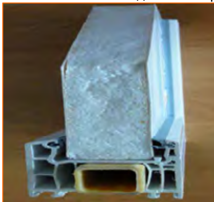
Рис. 2. Применение в ПВХ-профилях вместо стальных усилителей стеклопластикового армирования
