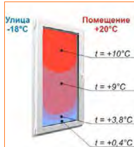
Рис. 1. Разброс температурных значений на поверхности стеклопакета со стороны помещения при температуре в помещении +20 \text{ }^\circ\text{C} и температуре наружного воздуха -18 \text{ }^\circ\text{C}
