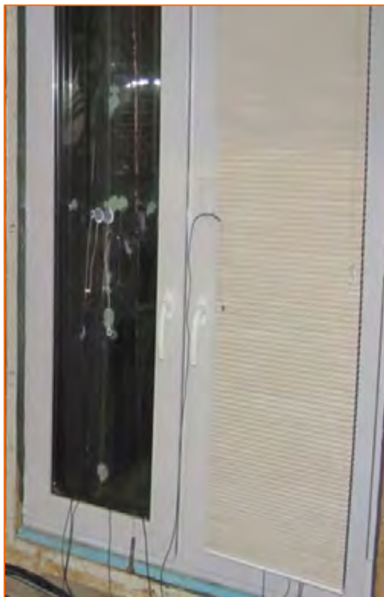
Рис. 2. Теплотехнические испытания энергосберегающих объемных штор в климатической камере «НИИМосстрой». а) термограмма с индикатором соответствия цвета температуре, б) профиль температур вдоль выделенной на термограмме линии Li1
